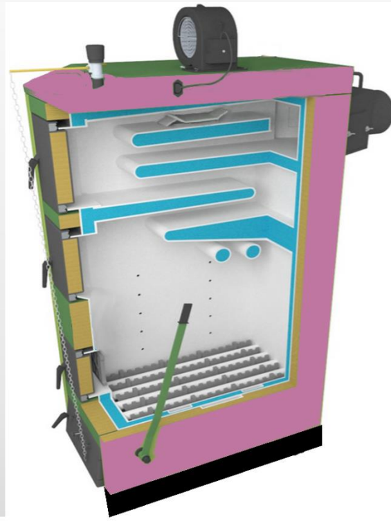
konstrukcja przystosowana do „górnego spalania”
